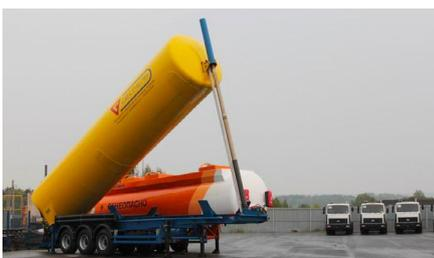
**Подъемная цистерна SB3U35.** Для изготовления используется алюминиевый сплав. Уровень грузоподъемности 25 тонн.
