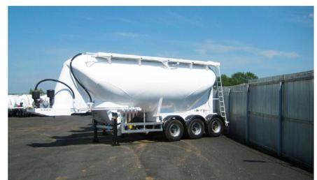
**Цементовоз SF3U34** обладает грузоподъемностью 35 тонн. Изготовлен из сплавов алюминия и оборудован компрессором.
