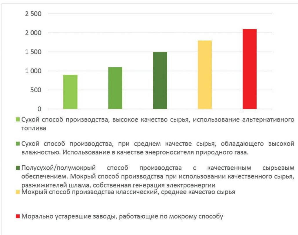
Рис. 1. Производственная себестоимость цемента на заводах с различными основными характеристиками (максимальный эффект составляет 52% по сравнению с устаревшими заводами)
